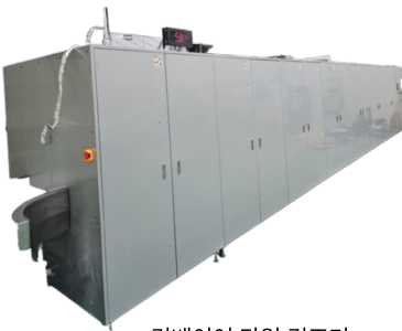
컨베이어 타입 건조기 생수 Pouch mw heater 설비 MICROWAVE POWER : 148kW 일처리량 : 2kw x 56ea 가변연속형
