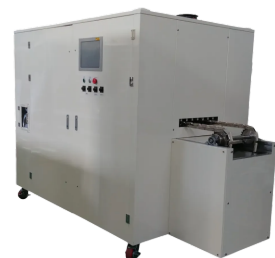
PVC 원단 MW 발포기 MICROWAVE POWER : 5kW 일처리량 : 2700 kcal
