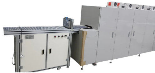
컨베이어 타입 건조기 SIC DPF 경유차량 filter 건조기 MICROWAVE POWER : 60kW 일처리량 : 10 T/D
